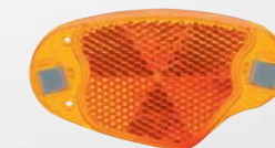
Speichen-Rückstrahler 309M Unverlierbar. Für alle Radgrößen. Mit Edelstahlklammern. Länge 85 mm. Montage: einfach in Speichen eindrehen. Prüfzeichen D, E.
