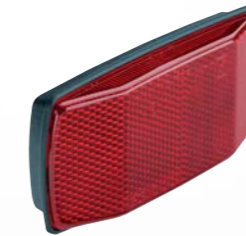
HECK BIG 316WZ Gepäckträgermontage, Schraubungen 50 mm und 80 mm Abstand. Mit 2 Schrauben. Prüfzeichen D (einschl. Z). Typ 316: mit flachem Reflektor.
