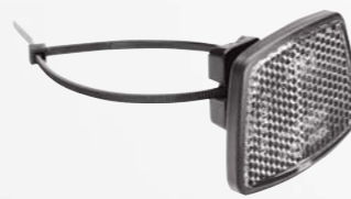
FRONT UNIVERSAL 313/5K Spannband und Gummieinlage für alle Rohrdurchmesser. Nur 10 g. Prüfzeichen D, E, GB. Auch in Rot: HECK UNIVERSAL Typ 313/1K. Siehe Seite 21.
