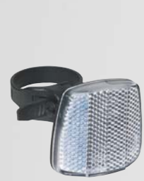
FRONT 313/5WB Vormontierte Kunststoff-Schraubschelle Ø 13-40 mm. Weitwinkelreflexion. Prüfzeichen B, D, E, GB. Auch in Rot: HECK Typ 313/1WB.
